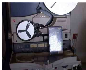
Srovnání velikosti profesionálního Sony jednopalece BVH3100 s kazetou půlpalcového systému VHS.
